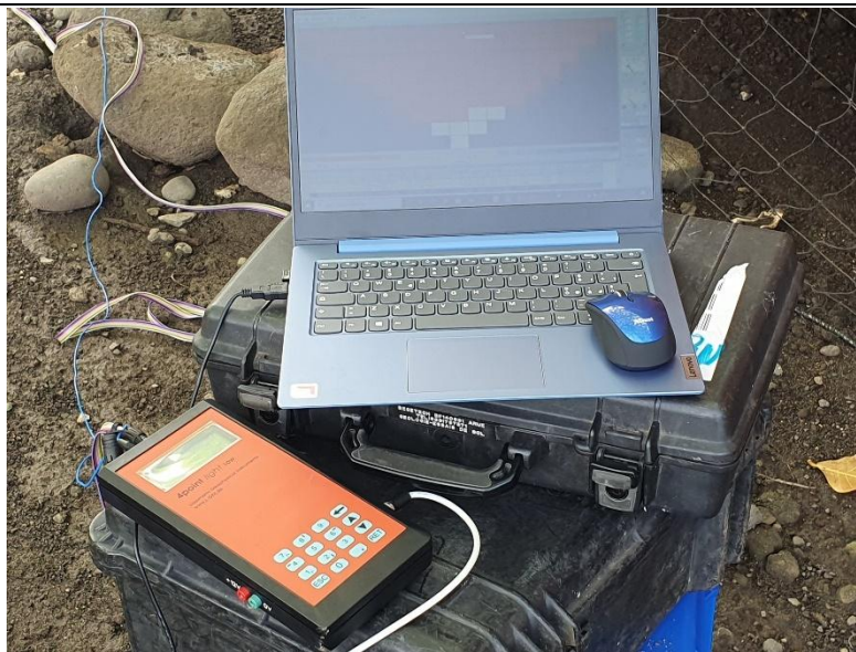
Figure 4 : Photographie du résistivimètre LIPPMAN utilisé pour les mesures
